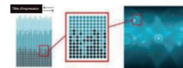
En fonction des conditions d'impression telles que le type de support/d'encre et la résolution, le motif de gradation le plus approprié est automatiquement sélectionné et imprimé
