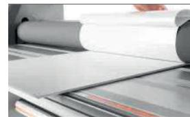
Table d'alimentation extra-profonde en aluminium idéale pour placer le support à laminier
