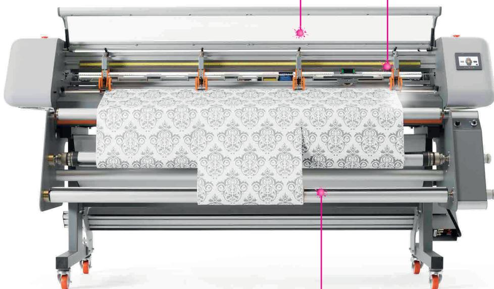
Machine de découpe très précise pour la coupe X et Y avec correction automatique de la coupe verticale et système de rembobinage.
