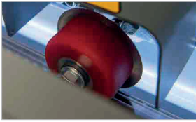
Lame circulaire auto-affûtante pour une fiabilité à long terme et aucun coût de service
