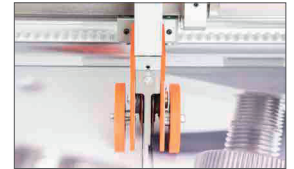
Fraise à écraser rotative dans le sens de la longueur (deux couteaux en option)
