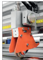
Système de coupe par écrasement rotative longitudinale mince, simple ou double (en option)
