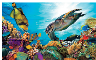
Chevauchement / Traces noires (Alimentation papier insuffisante)
