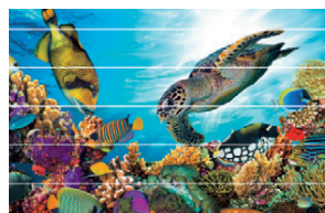
Écart / Traces blanches (Alimentation papier excessive)
