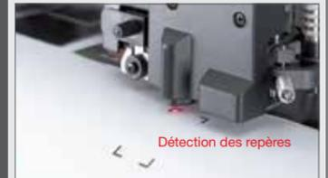
La détection en continu d'un maximum de 4 repères permet de découper les images imbriquées, dans les axes X et Y, avec un alignement automatique. En cas d'utilisation du logiciel FineCut de Mimaki, un seul repère suffit.
